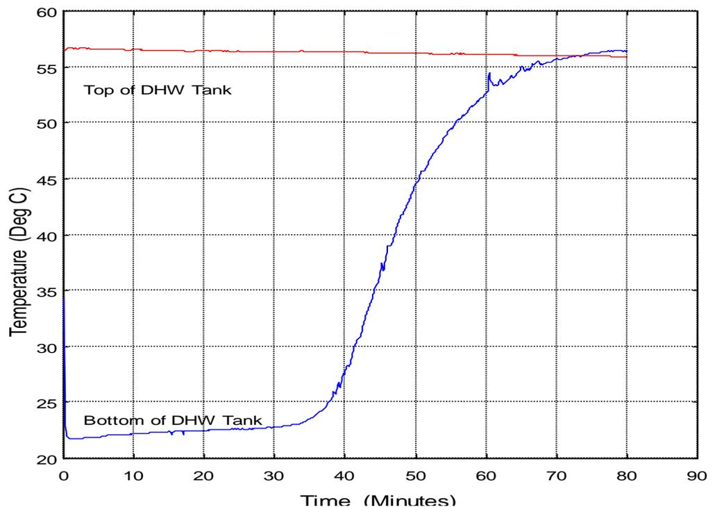
Figure 33: DHW Tank Recovery from 23°C
